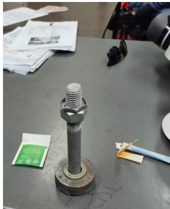
Foto bout en afgebroken steel met ring, moer en volgmoer
