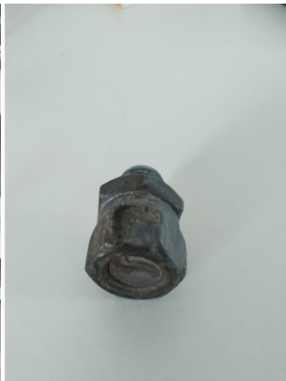
Foto bout en afgebroken steel met ring, moer en volgmoer
