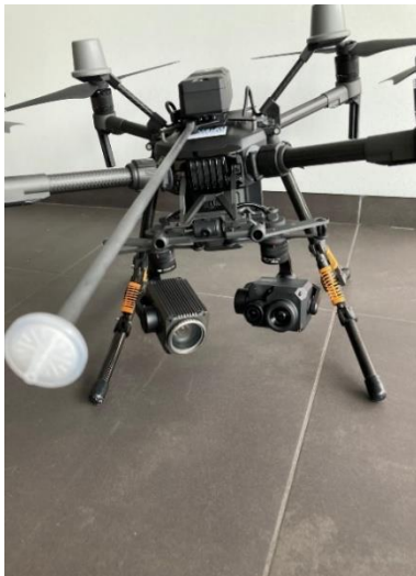
Drone Matric 210 met warmtebeeldcamera en stoffensensor FLIR MUVE 360
